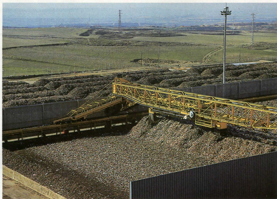
Planta de compostaje en Madrid para RSU recogidos sin separación en origen. Foto: Gaia
